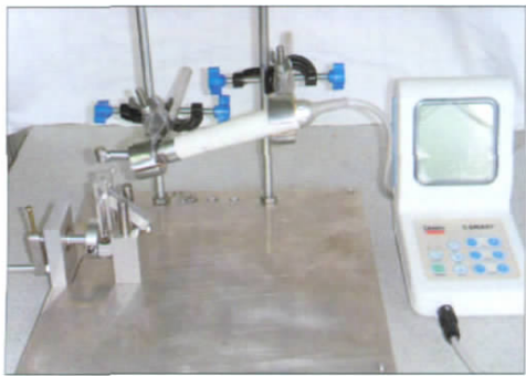
图 1 电机固定装置示意 Fig 1 The appliance for fixing motor
