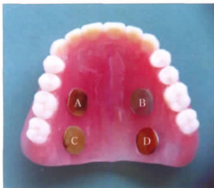
A: 阳极氧化膜组; B: 空白对照组; C: TiN薄膜组; D: N-DLC膜组。
